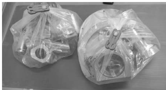
Fig.14 バグアウトチューブによる部品取り出し
