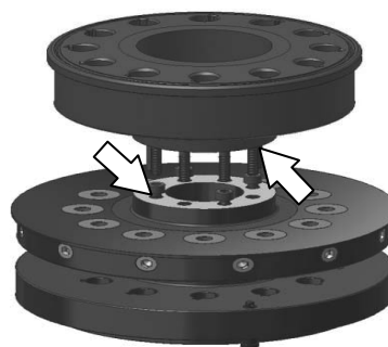
Fig.11 回転盤上部、下部の接触面
