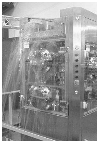
Fig.21 錠剤機外装防水 (IP65) 構造
