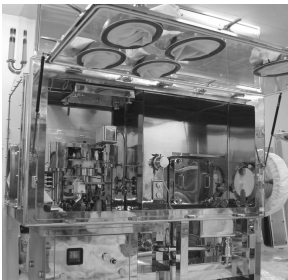
Fig.9 アイソレータ内に洗浄用シンクを設けた打錠機 VELC-M
