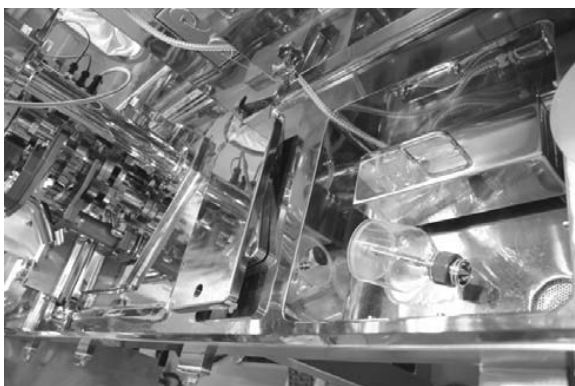
Fig.10 アイソレータ 左：打錠機、右：洗浄用シンク
