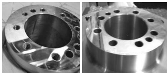
Fig.12 回転盤上部、下部の接触面鏡面ラッピング面
