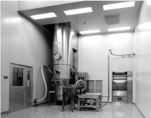
Fig. 4 パールチェーン方式（空気輸送により工程間を接続）
