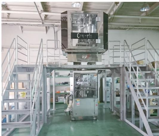
Fig. 3 直打連続生産システム CRA-RIS SYSTEM 全体
